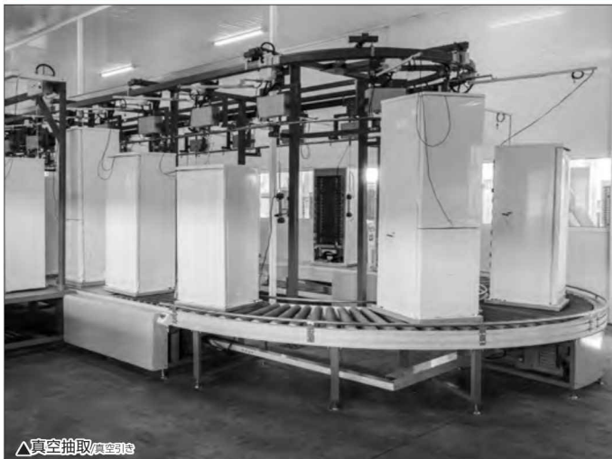
△真空抽取/真空引き
