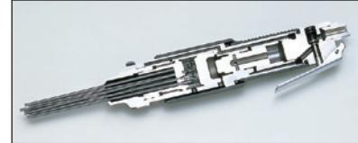
“JET CHISEL”的针束针对作业面的凹凸不平、以每分钟4,000~4,500转的高速往复运动去除加工物表面的附着物
