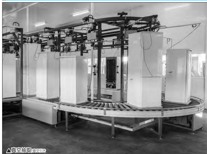
△真空抽取/真空引き
